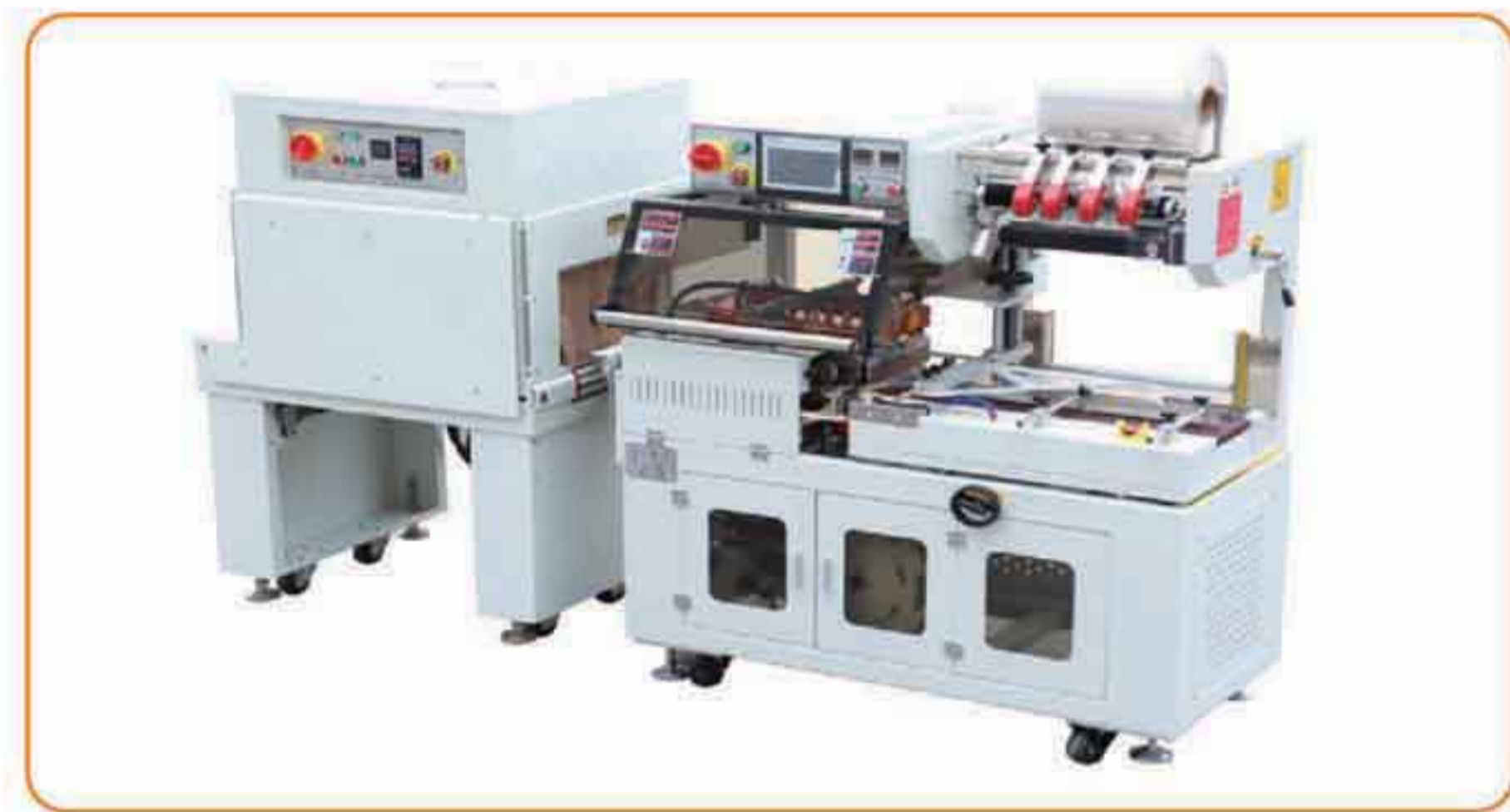
SF-300LAC+SF-4525迷你型全自动L型封切收缩包装机 Mini Fully-auto L Bar Sealer & Shrink Tunnel
